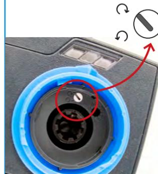
Abb. 9. Drehrichtungsschalter des Stellantriebs
