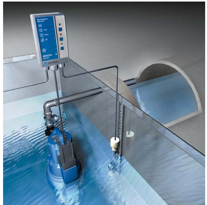
Bei Erreichen des Grenzstandes im Sammelbecken steuert das Warngerät WWG den Entleerungsvorgang über eine angeschlossene Pumpe.
