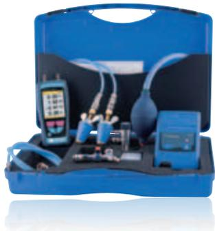
DPK 60-6 eignet sich bestens zur Durchführung der Belastungs-/Dichtheitsprüfung und Druckmessung (Verschlusskontrolle) an Niederdruck-Gasleitungen gemäß TRGI 2008. Die einsatzfertige Dichtprüfgarnitur ist ausgestattet mit einem elektronischen Druckmessgerät (-1.000/+1.500 mbar),
