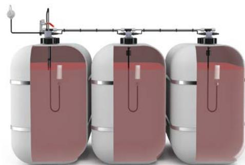
Anwendungsbeispiel: Universelle Entnahme für drei Batterietanks mit Grenzwertgeber, Schwimmerschaltern und schwimmender Entnahme.
