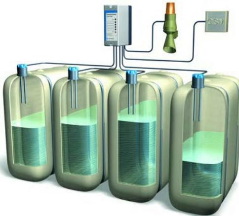
*Bild 1: Bis zu 4 Zonen / Bereiche überwachbar*
