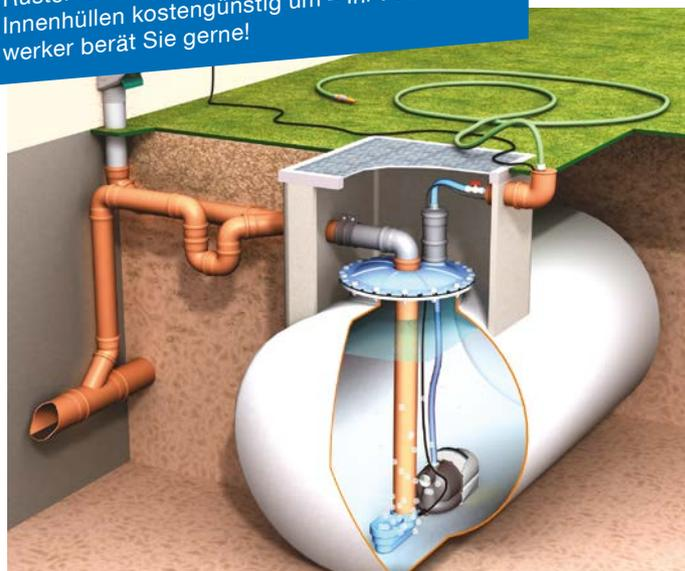
Beispiel eines Regenwassernutzungssystems zur Gartenbewässerung, bestehend aus einem umgerüsteten Heizöltank mit Regenwasser-Innenhülle AR-SM, Fallrohrfilter, Patronenfilter, Domdeckel, beruhigtem Zulauf und Tauchpumpe.
