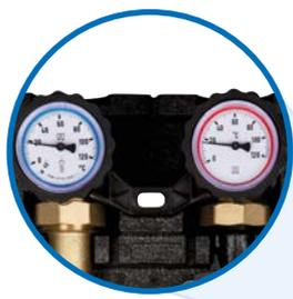
Kombihähne mit Thermometer im Handrad, Anzeigebereich 0/120 °C. Rote/blau Kennung erleichtert die Zuordnung „Vorlauf-/Rücklaufstrang“ und Funktionskontrolle für den Anlagenbetreiber. Die Aufnahme hinter dem Kugelhahn ermöglicht die Integration weiterer Temperaturfühler (z. B. PT 100).
