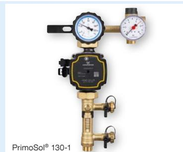
**Anwendung** Solarpumpengruppe/-strang zur Verbindung von Kollektor und Speicher in eigensicheren, geschlossenen thermischen Solaranlagen. PrimoSol® 130 wälzt Wärmeträgerflüssigkeiten wie z. B. Wasser-Glykol-Gemische im Gesamtsystem um.
