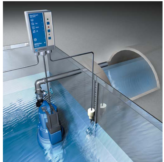
Bei Erreichen des Grenzstandes im Sammelbecken steuert das Warngerät WWG den Entleervorgang über eine angeschlossene Pumpe.
