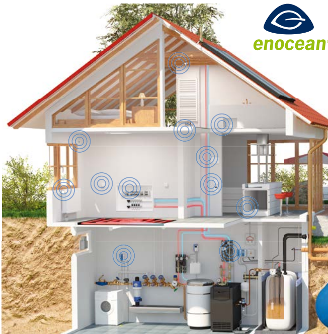
AFRISO Smart Home: Überwachung und Steuerung von Haustechnikanlagen, Wohnungen und Gebäuden auf Funktion und Leckage mit dem AFRISOhome Gateway. Durch Verknüpfung der Sensoren, Aktoren und Warngeräte werden Gebäudesicherheit und Wohnkomfort gesteigert. Einsatzbeispiele: Heizungsanlagen, Waschräume, Keller, Hauswirtschaftsräume und Trinkwasserinstallationen.
