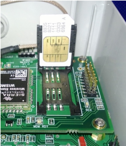
Bild 10: Installation der SIM-Karte im EMS 442
