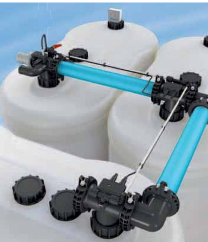
Überfüllsicherung UFS 01 für wassergefährdende Flüssigkeiten mit optischem/akustischen Alarm, Prüf- und Quittiertaste.
