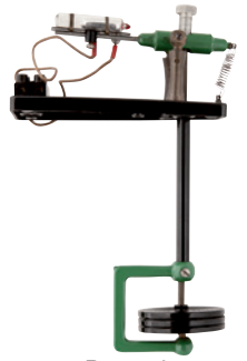
Das erste Patent für „Membran-Temperaturregler mit Quecksilberschaltröhren“ bildete gleichzeitig die Grundlage für den Einstieg in die Manometrie.
