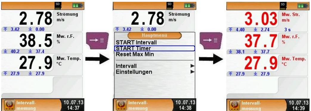
Um die Timer-Funktion zu stoppen, muss man zuerst das Hauptmenü aufrufen. Mit "STOP Timer" wird die Mittelwertmessung beendet und die Mittelwerte werden festgehalten. Dabei wechselt die Schriftartfarbe der Mittelwerte von rot nach schwarz.
