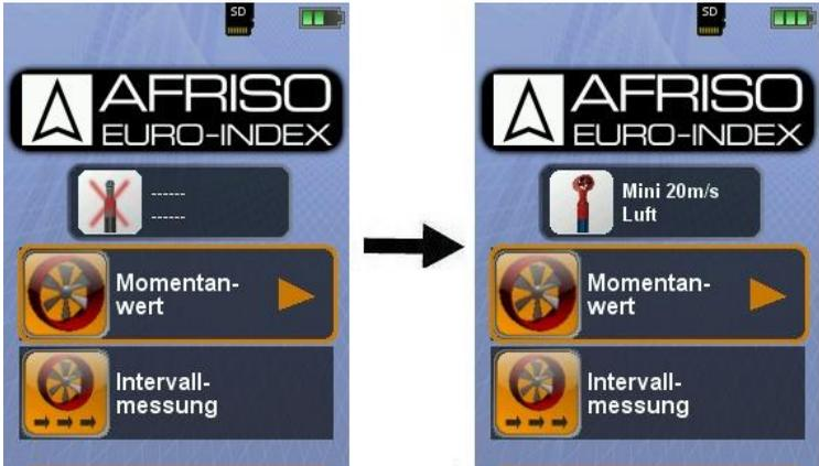
Bild 2: Bsp.: Verbindungsaufbau mit einer "MiniAir"-Sonde
