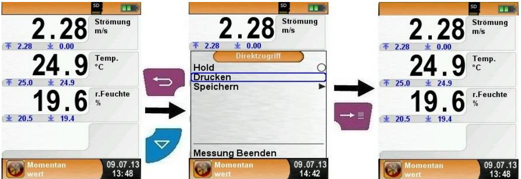
Sobald der Druckbefehl erfolgt ist, wird parallel zum Messbetrieb das Messprotokoll ausgedruckt (→ Multi-Tasking-Funktion), d. h. ohne Einschränkung des Messbetriebs.
