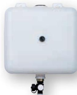
Der Solar-Auffangbehälter wird direkt am Membran-Sicherheitsventil oder der Sicherheitsgruppe der Solarpumpengruppe angeschlossen und sammelt die ausgeschiedene Flüssigkeit bei Systemüberdruck. SolarControl® gibt automatisch Alarm, wenn der Behälter voll ist.
