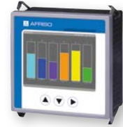
Mehrkanal-Prozessanzeige MPA 10 mit integriertem Datenlogger, 8 analogen Normsignaleingänge, Touchscreen- und Remotebedienung, 40 konfigurierbare Anzeigeelemente
