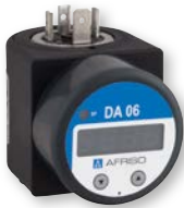
Digitale Aufsteckanzeige DA 06 für Messumformer mit 4–20 mA, Ausgang und Stecker nach ISO 4400 oder M12 x 1
