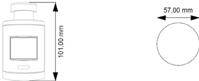
Bild 3: Abmessungen
